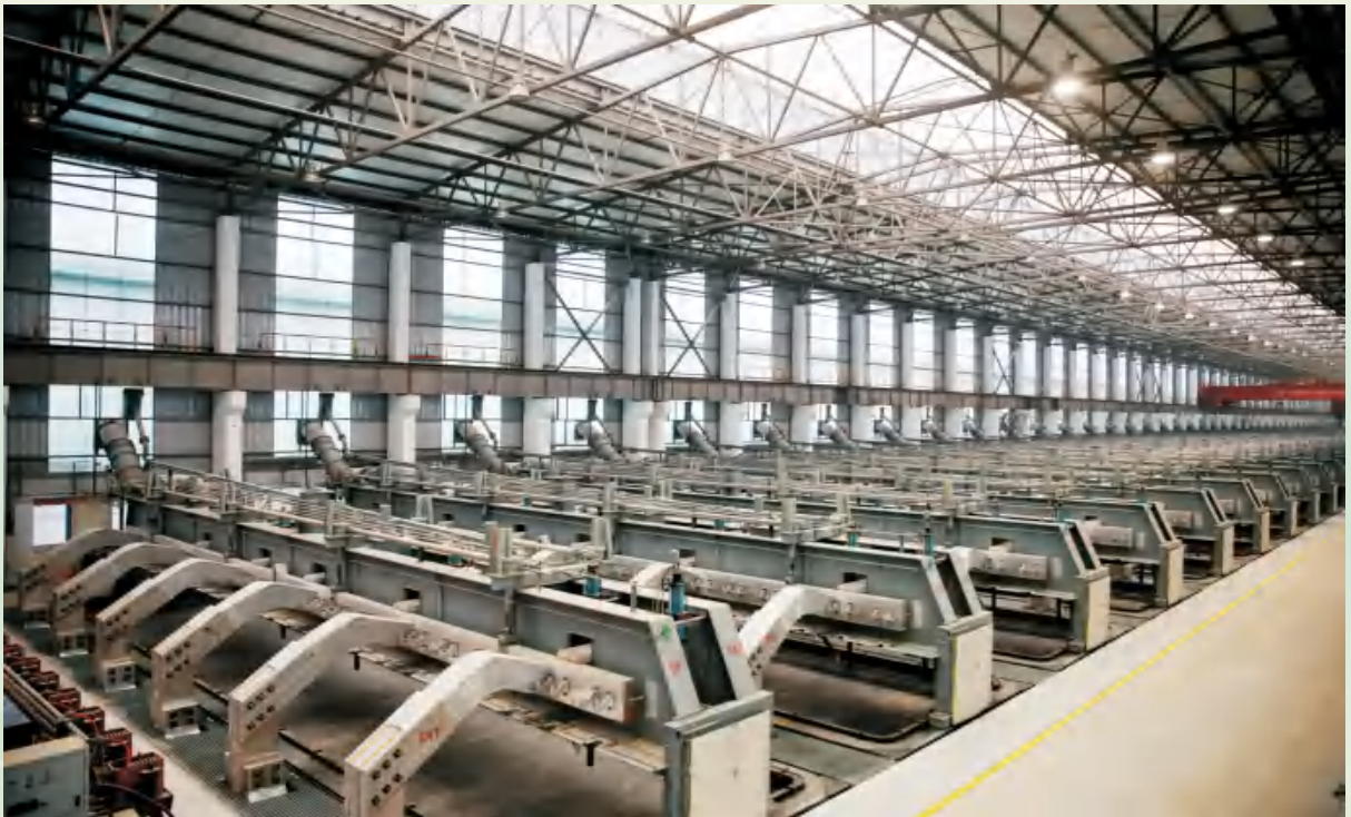
12月12日，年产30万吨铝镁合金项目首批电解槽通电焙烧
