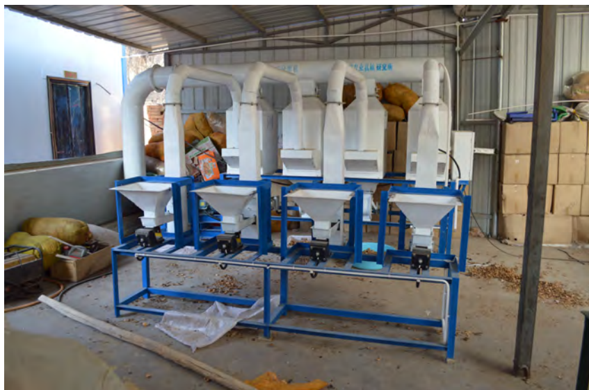
省农机研究所研制的核桃壳仁分离机
