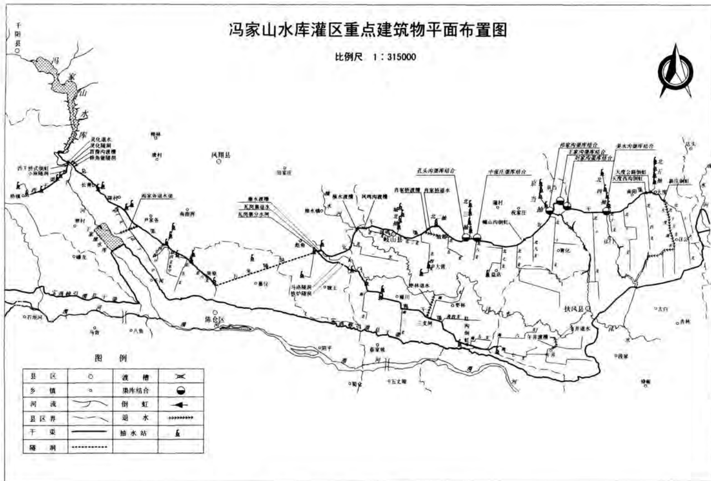
图 4-1 冯家山水库灌区重点建筑物平面布置图
