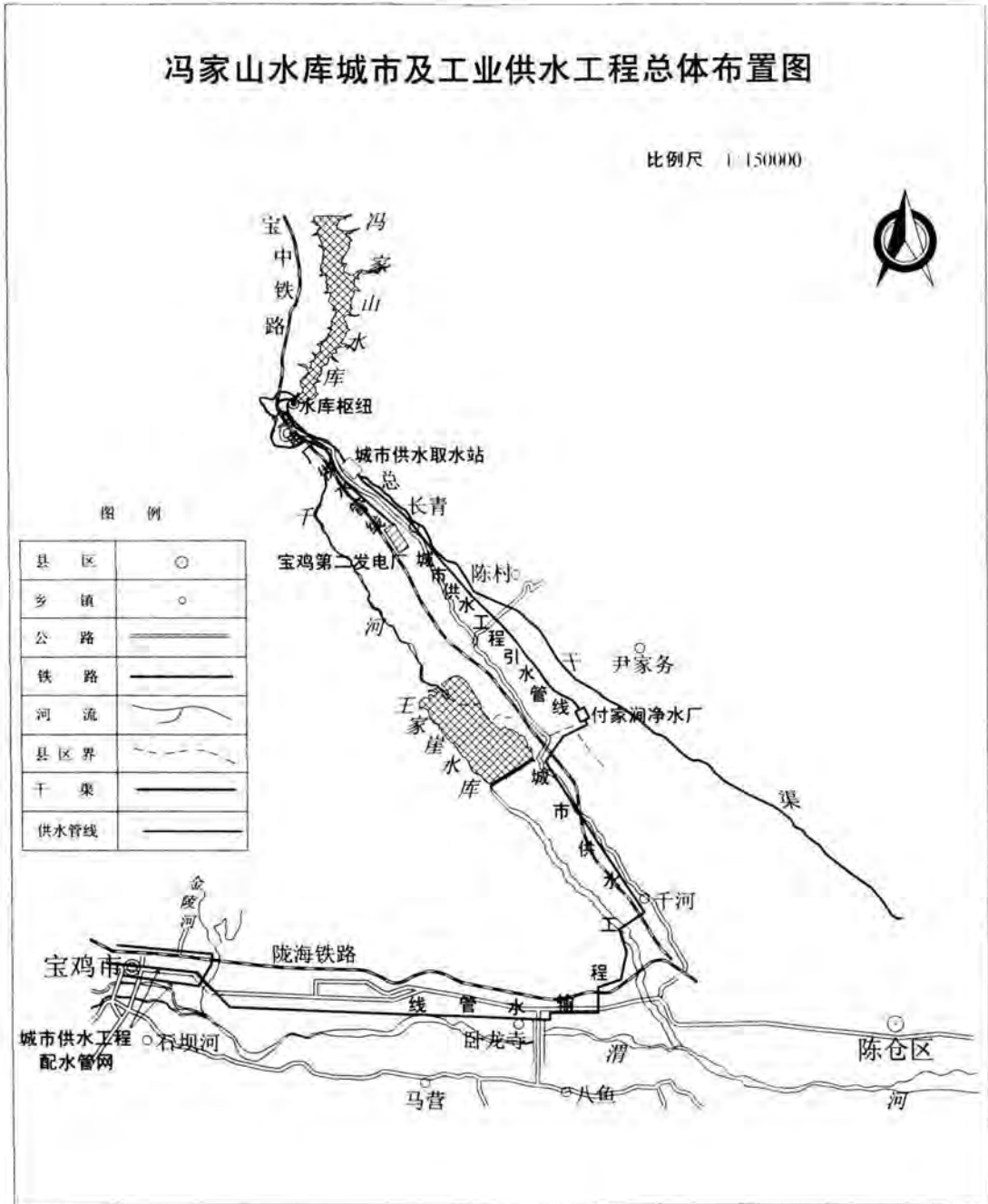
图 9-1 冯家山水库城市及工业供水工程总体布置图
