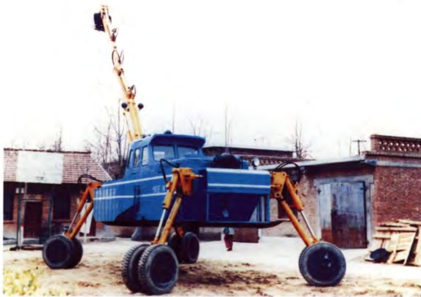
八十年代机械施工队试制水陆两用清淤机械
