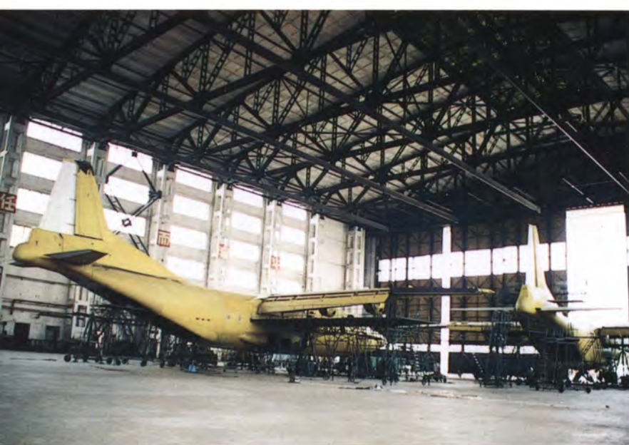
70年代建成的陕西飞机制造厂,拥有亚洲最大跨度的飞机总装厂房和配套的生产设施。图为正在总装“运八”飞机。
