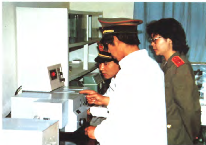
法医工作者正在操作紫外分光光度计，进行毒物分析鉴定
