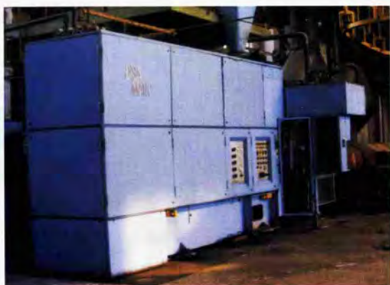
引进丹麦迪萨公司高压无箱垂直分型造型线
