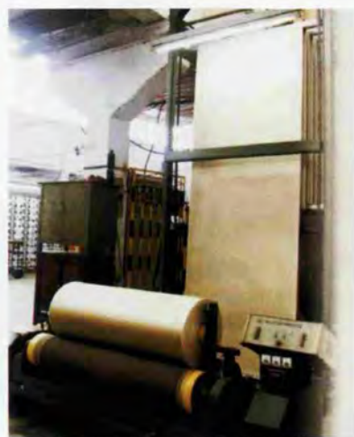
高硅氧纤维布后处理车间
