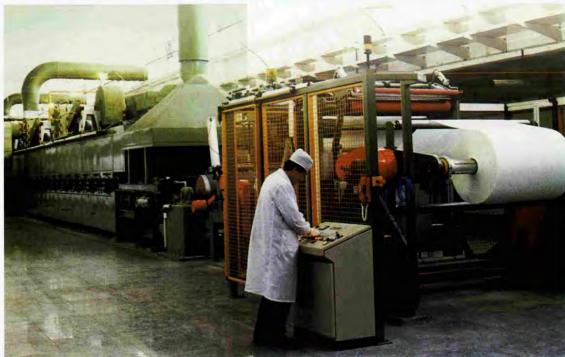
引进德国技术设备建设的玻璃纤维湿法薄毡生产线
