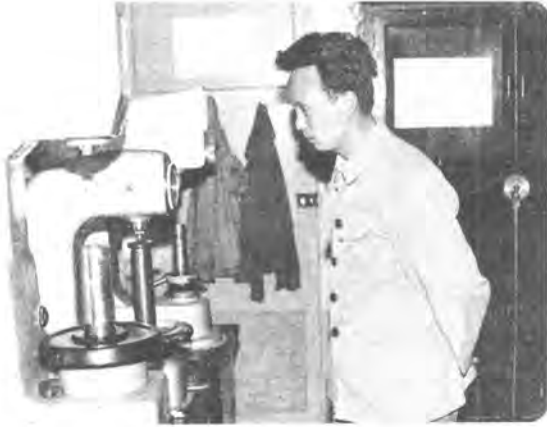
检验员用硬度计对进口金属材料进行硬度测试
