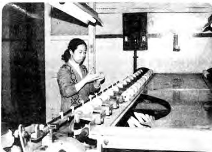
检验员对出口桑蚕丝作切断试验
