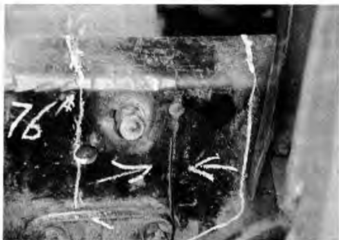
从日本进口的汽车发现大梁断裂
