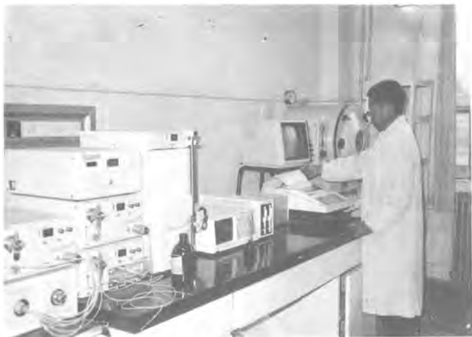
用液相色谱仪测试出口食品中农药残留量
